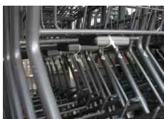
Fig. 7: ショッピングカートに装着したRFIDタグ
