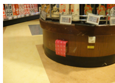
Fig. 8: 店内に装着したRFIDタグ
