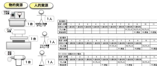
fig. 3.4 3つのロットに対するスケジュールリング事例
